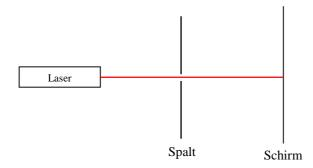
Mit abnehmender Spaltbreite weitet sich das Laserlicht mehr und mehr auf (Beugung).
